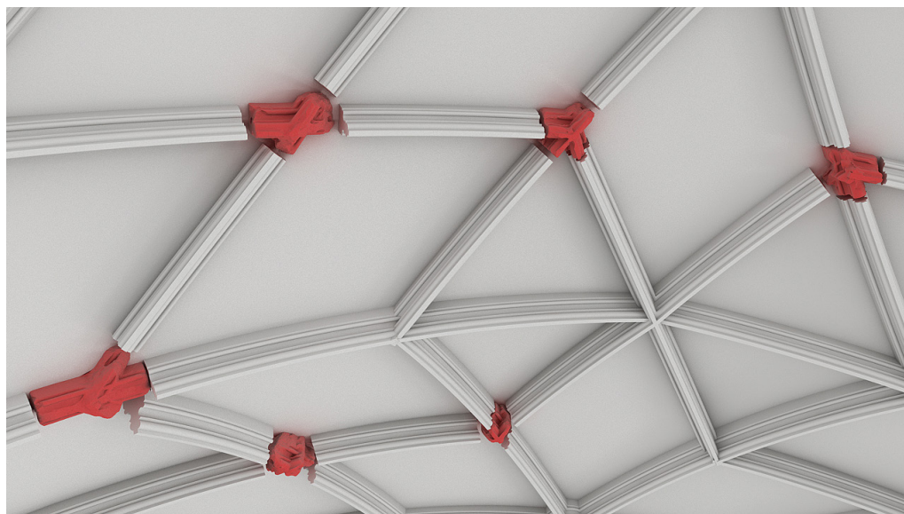
4. kép: A székesfehérvári Szűz Mária prépostság egykori hálóboltozatának elméleti rekonstrukciós modellje a beillesztetett kőfaragványokkal. SziMe3D AR, Pazirik Informatikai Kft.
